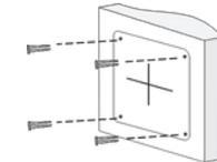
**3. Solte a contra-porca da base da câmera e deixe os cabos para fora da parede. Conecte todos os cabos e os proteja de contato com água. Monte a câmera na parede com parafusos autorroscantes.**
