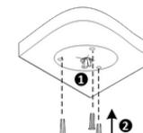
**4. Passe o cabo de força pela base. Prenda a base ao suporte usando a chave de fenda adequada.**
