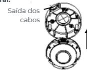
**3. Fixe o produto e o suporte com os parafusos e finalize encaixando o anel novamente.**
