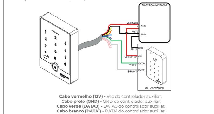
Quando utilizar um relé externo, insira um diodo em antiparalelo à bobina do relé. Conecte um dos cabos rosa ao negativo do relé e outro cabo rosa ao GND. O positivo do relé deve ser conectado à alimentação do mesmo.
